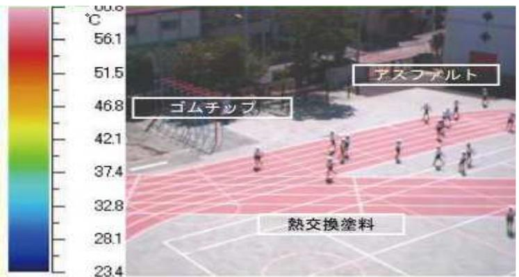
グラウンドの大半を塗装した熱交換塗料は、施工後1年を経過していますが、気温33.5°Cで、表面温度4.0-4.5°Cとなり、裸足で歩ける温度を維持しています。サーモグラフ画面上の最高温度は、左上のゴムチップ遮熱塗料面です。グラウンドの照り返しがなく、児童の体温は平熱を維持しています。ゴムチップやアスファルトは5.0-6.0°Cで大変熱く、裸足では歩けません。
