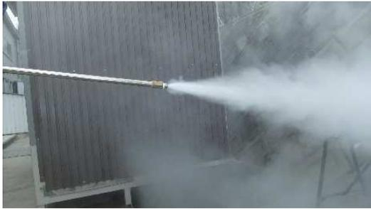
現状機器で194℃まで上昇可能であった。190℃近くになると気化スピードが速いためかノズル先で膨張している
