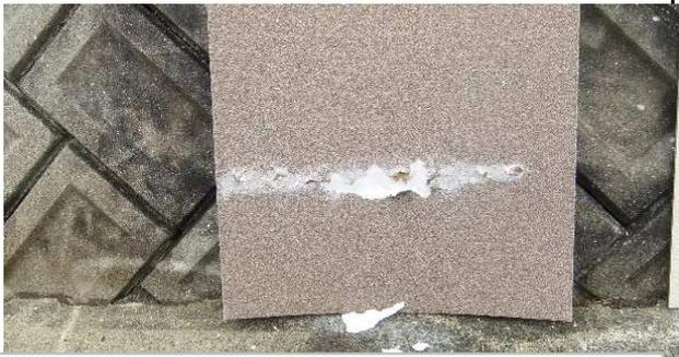
ボードの糊が熱で溶けて崩壊してしまった。
