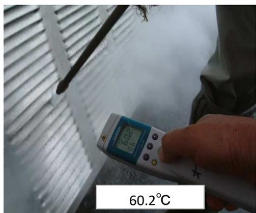
ノズルを動かさずに一カ所に固定して熱水洗浄すると
